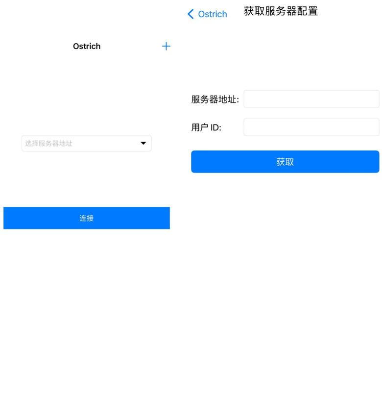
4. 点“获取”，弹出的窗口点“无线局域网与蜂窝网络”。再点“获取”，弹出“配置服务器成功”，窗口自动关闭。回到主界面，点“连接”。
